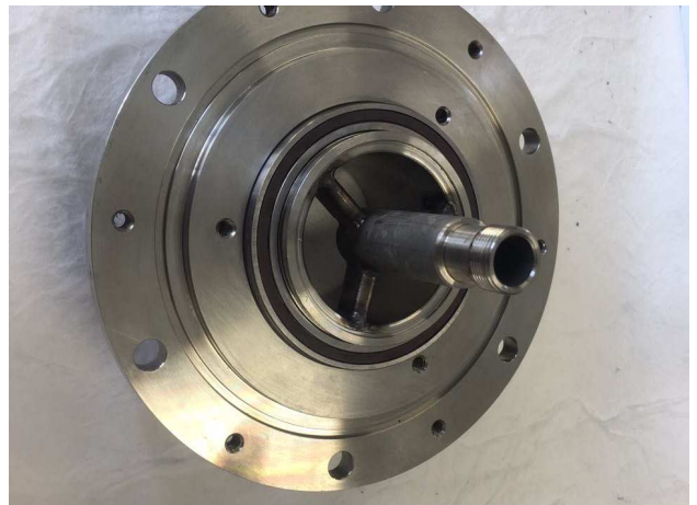
Montagem rolamento principal
