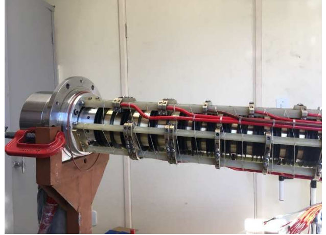
Reamarrção e condicionamento dos fios
