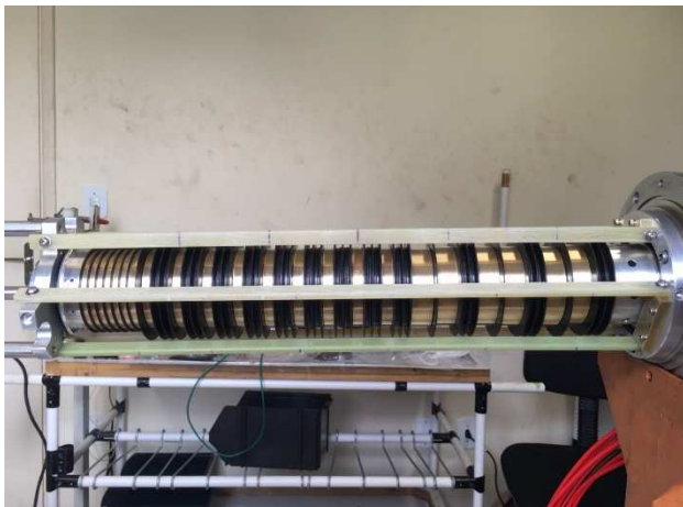
Vista lateral - montagem dos anéis
