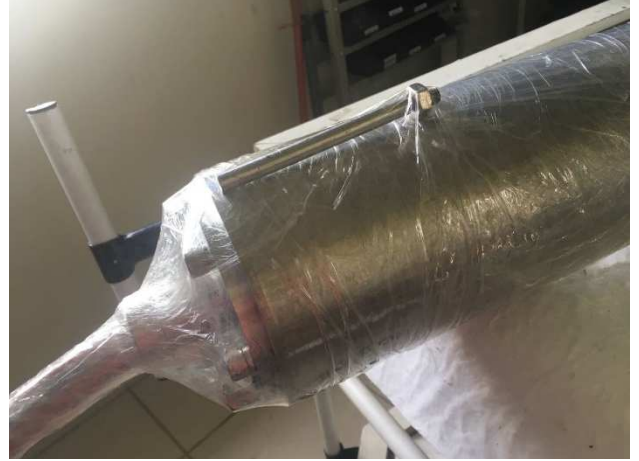
Pino trava preso ao corpo do SR para fins de transporte
