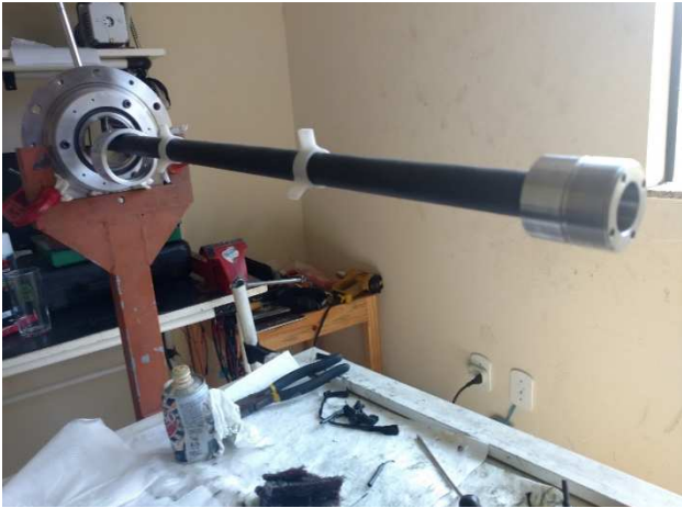
Recapeamento do eixo com termo retrátil
