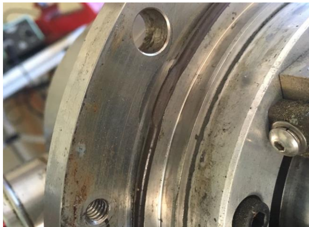
O'ring do flange principal danificado (Figura 1)
