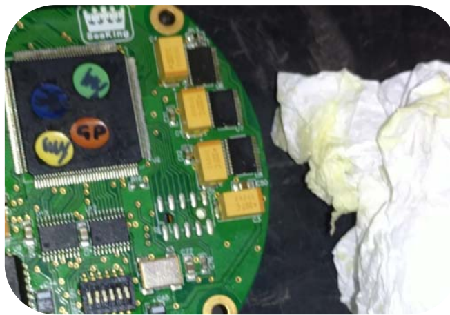
Placas internas sendo limpas do óleo
